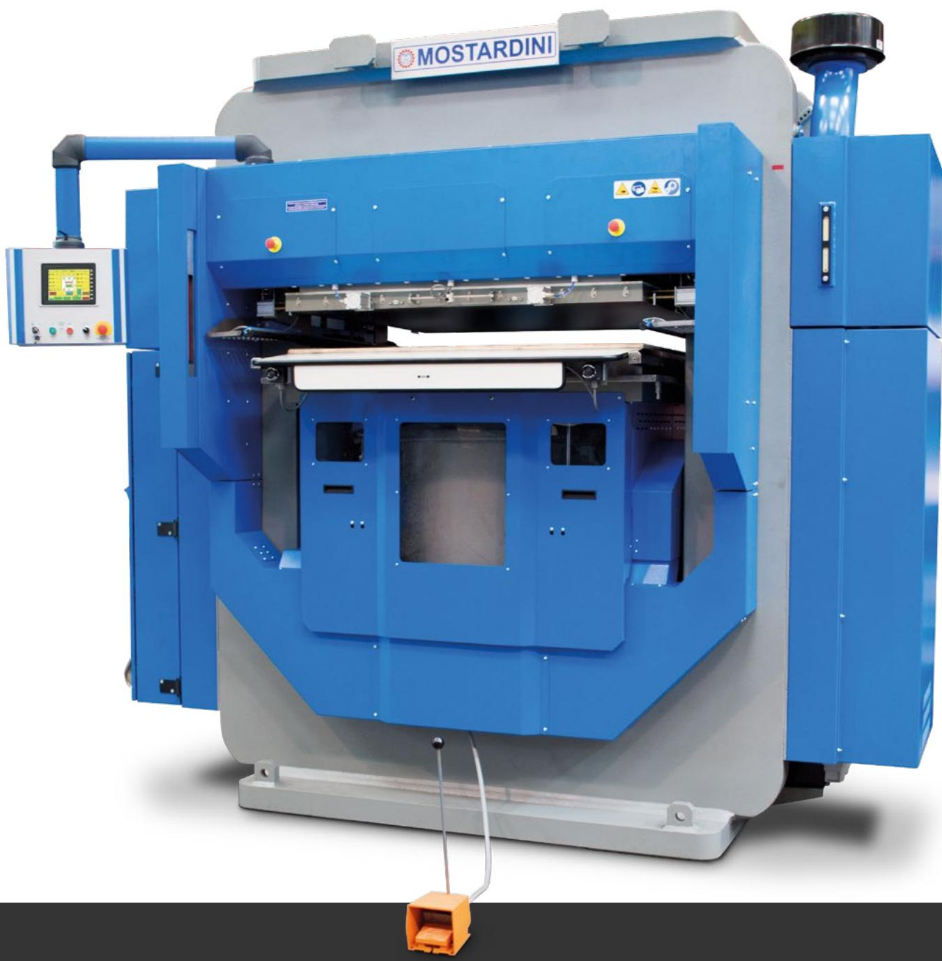
A nova Mostardini MPTSX é a prensa tecnologicamente mais evoluída no mercado para prensar, estirar e amaciar. O sistema de controlo é gerido por um PLC que torna as operações na máquina simples e rápidas, facilitando as operações de manutenção graças ao sistema de autodiagnóstico.
